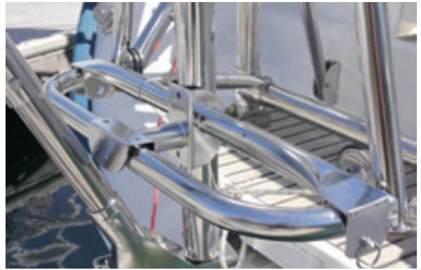
Strebe zum Arretieren des Pendelarms
